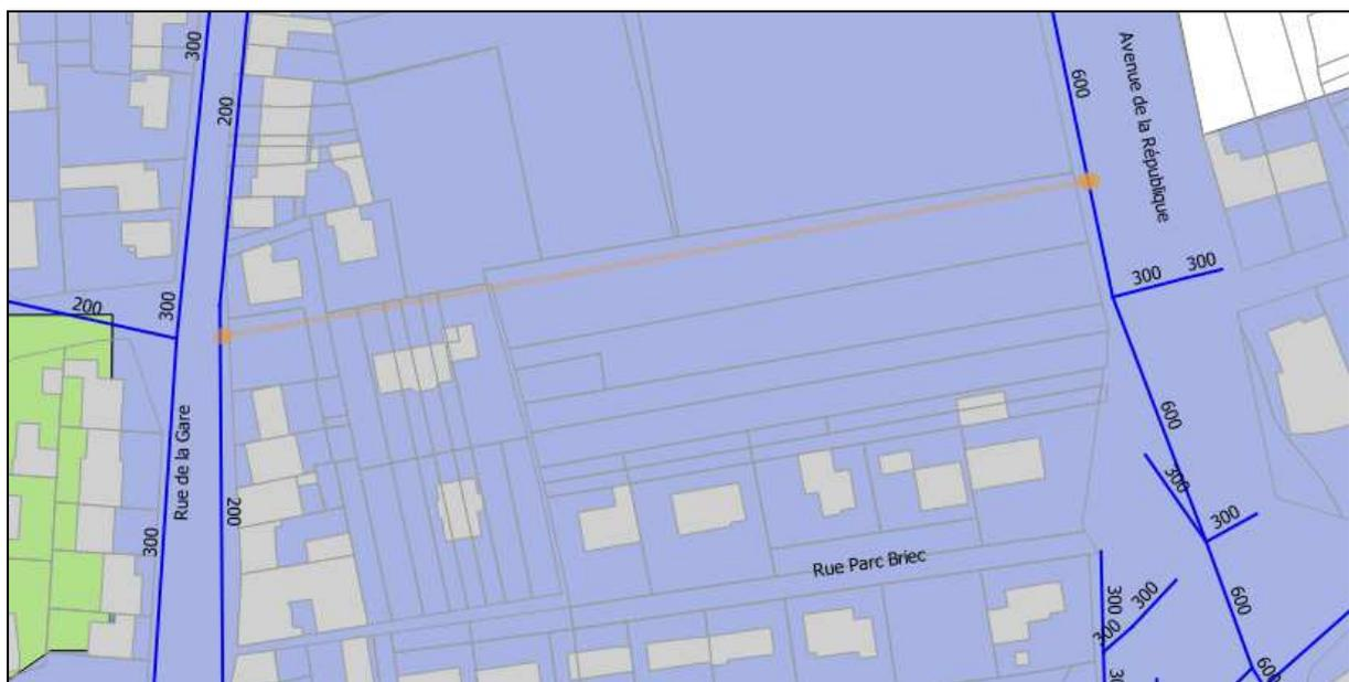
Cette déviation des réseaux pourra permettre la mise en place d'une rétention de 560 m<sup>3</sup> pour contenir le ruissellement lié à une surface interceptée de 6.40 ha imperméabilisée à 38% et obtenir un rejet à 20 l/s.
