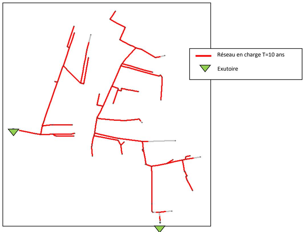
Figure 24 : Mise en charge des réseaux établie par modélisation – Pluie 10 ans
