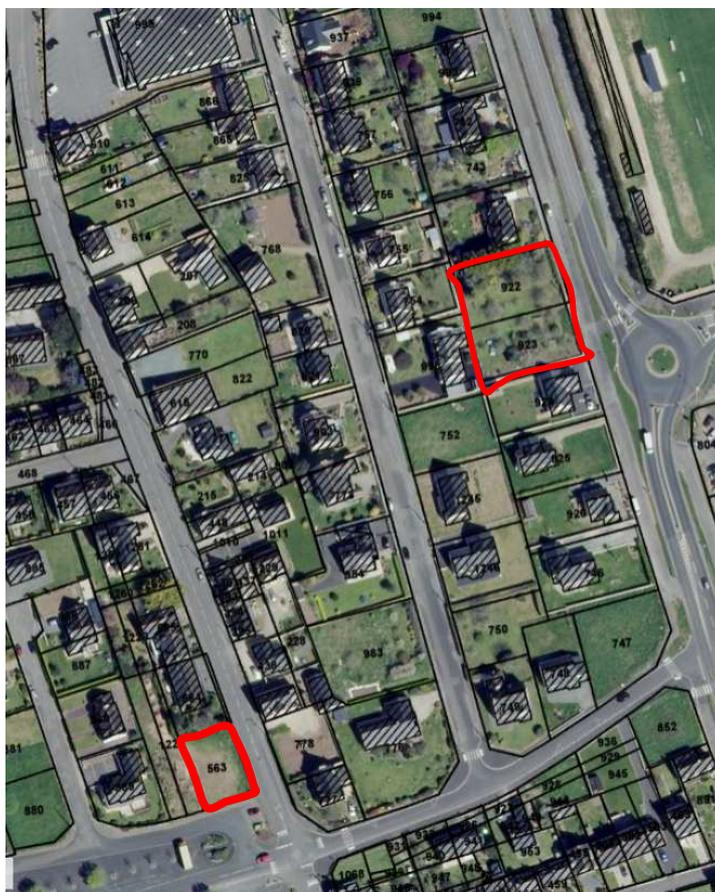
Le bassin situé sur la parcelle Ouest rue de la Gare intercepterait un bassin versant amont de 2.81 ha imperméabilisé à 42 %. Le volume de rétention à mettre en place serait de 285 m<sup>3</sup> avec un débit de fuite de 8.5 l/s.
